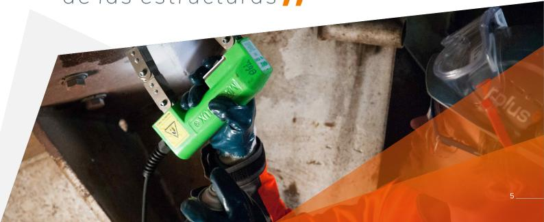
Ultrasonic Testing (PAUT) es una técnica avanzada de examen no destructivo que utiliza un conjunto de sondas de prueba ultrasónica (UT) formadas por numerosos elementos pequeños, cada uno de los cuales se pulsa individualmente con temporización calculada por computadora.
